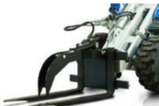
ПАЛЛЕТНЫЕ ВИЛЫ С ГИДРАВЛИЧЕСКИМ ЗАЖИМОМ
